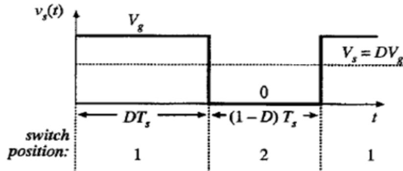
$$\langle v_s \rangle = \frac{1}{T_s} \int_0^{T_s} v_s(t) dt = \langle d \rangle \cdot \langle v_g \rangle$$
